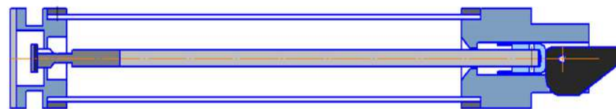
Положение 3 – Клапан открыт для слива воды, а также забора воды при отсутствии волнения
